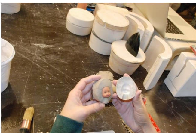
Første halvdel av dukkehodet er støpt i gips. Nå skal leiren fjernes og bakhodet skal støpes i en liten form.
